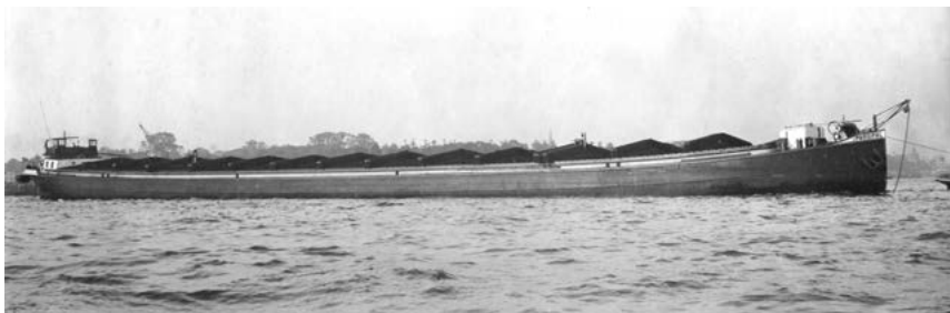
Het gesleepte rijnschip Parsifal was een 3000 tonner. Gebouwd door C. van der Giesen & Zonen in opdracht van de Transport-Maatschappij. Bouwjaar 1912. Het schip is te zien op zijn stuurboordzijde en wordt in ballast gesleept; de luiken boven de ruimen liggen open. COLLECTIE MARITIEM MUSEUM ROTTERDAM
