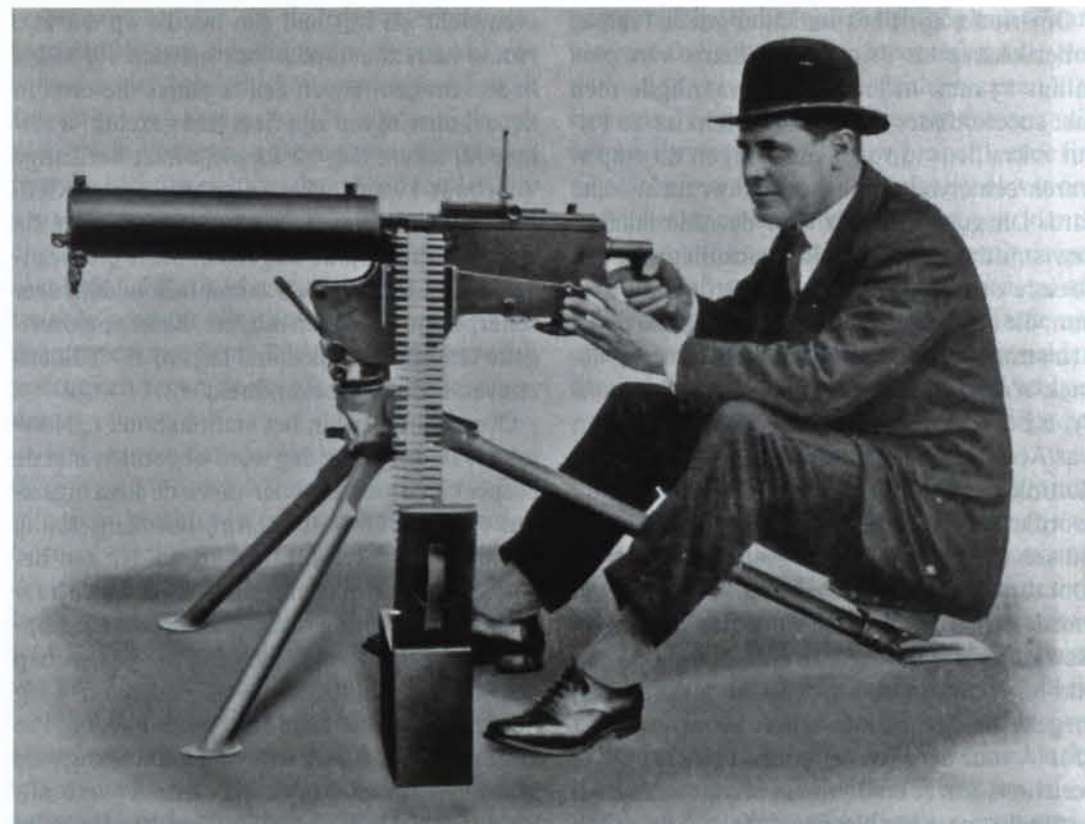
Afb. 3. Mitrailleur van 7,7 mm Colt-Browning, uit een brochure van de firma Sir W.G. Armstrong Whitworth and Co., Newcastle-on-Tyne van maart 1927. De Nederlandse officieren hebben de man met de bolhoed daadwerkelijk ontmoet als een van de mitrailleursexperts van de firma.
