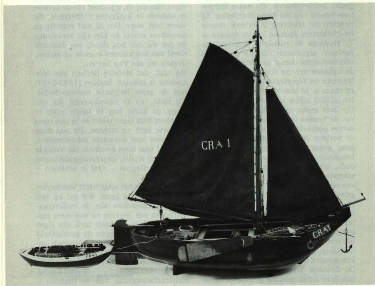
Volmodel van de hengst GRA 1, schaal 1:10, gebouwd door J. van Beylen op basis van gegevens ontleend aan een in 1950 in de haven van De Paal (Zeeuws-Vlaanderen) opgemeten schip van dit type. Rijksmuseum 'Nederlands Scheepvaart Museum', Amsterdam
