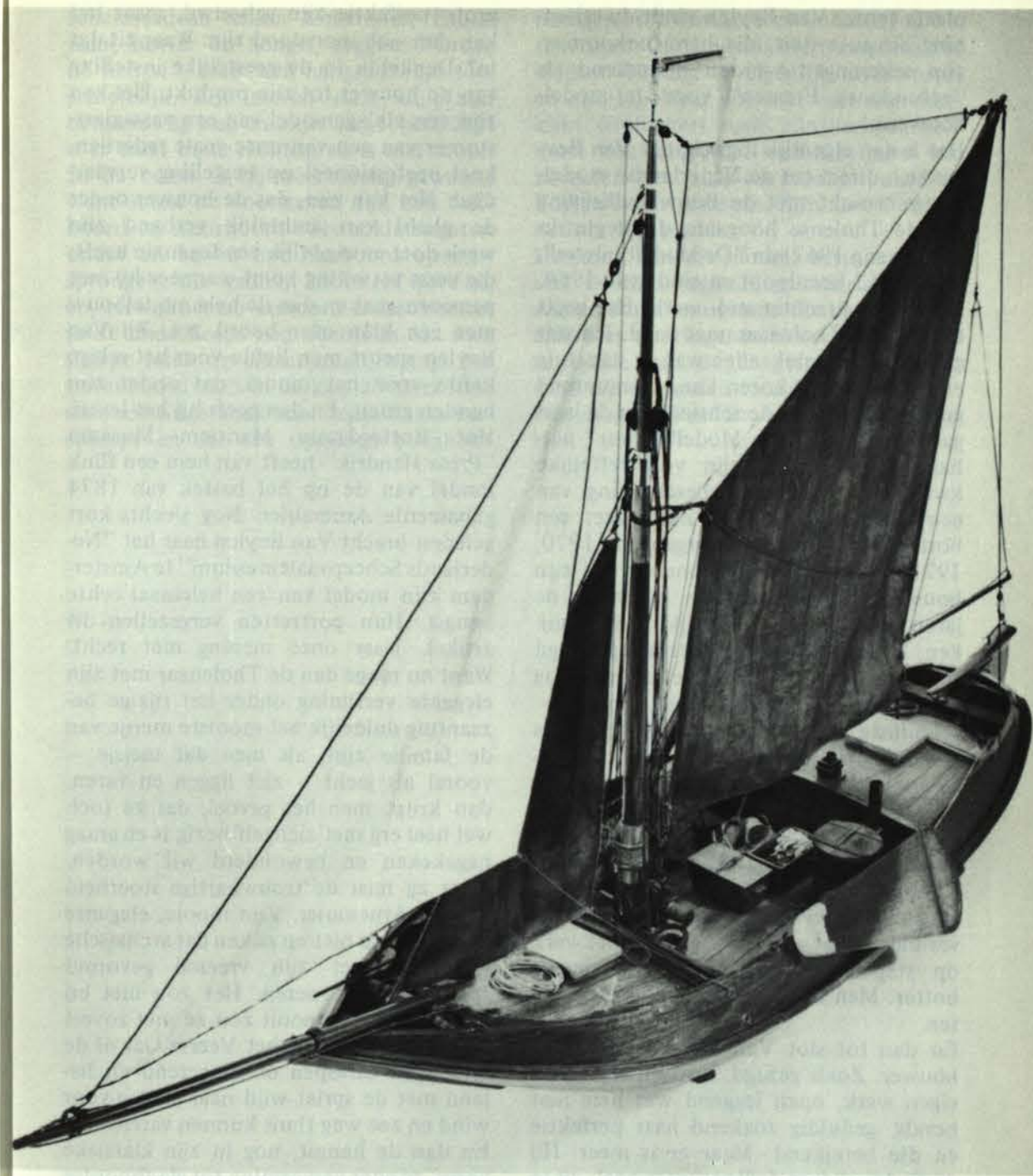
Model van een Arnemuider hoogaars, schaal 1:10, gebouwd door J. van Beylen naar tekeningen van zijn hand, die zijn gebaseerd op een origineel bestek uit 1874 van de werf Meerman te Arnemuiden. Maritiem Museum 'Prins Hendrik', Rotterdam
