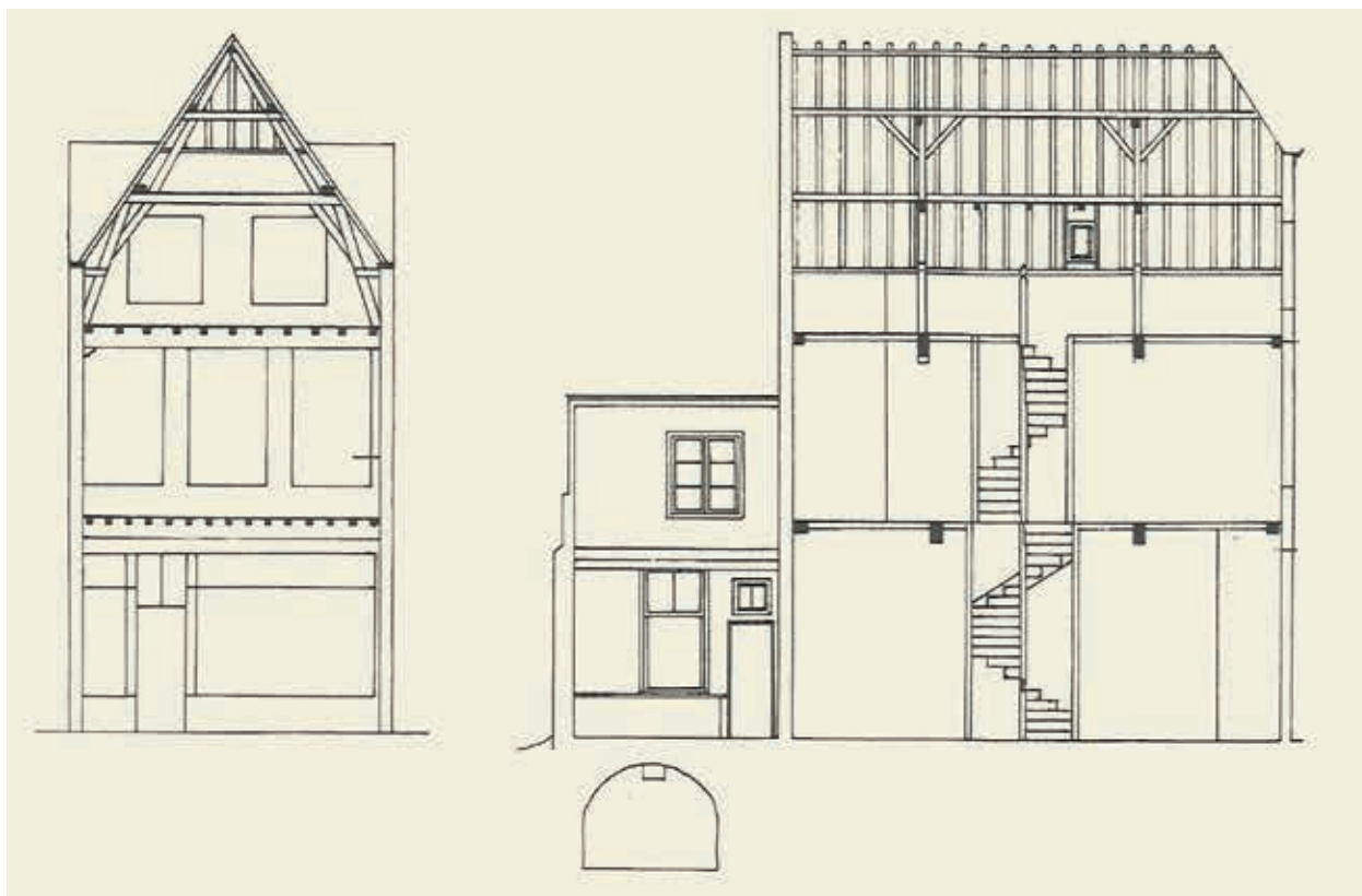
8. Een jongere vloer met moer- en kinderbinten in Haverstraat 30, Utrecht (1643), uitgevoerd in grenenhout waarbij een halfsteens tussenmuur fungeert als middelste 'moerbalk' (tekening auteur)
