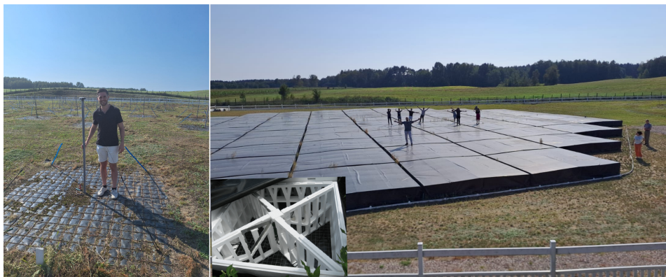
Figure IV: Verschillende LOFAR antennes. Links is een LBA antenne te zien met een mens er naast om de schaal te verduidelijken. In het midden wordt een afbeelding van een HBA antenne getoond, die verborgen ligt onder de tegels getoond in de rechter afbeelding, waar mensen bovenop staan om de schaalgrootte aan te geven. Deze foto's zijn genomen bij station PL612 in Baldy (Polen) door de auteur en zijn collega's.
