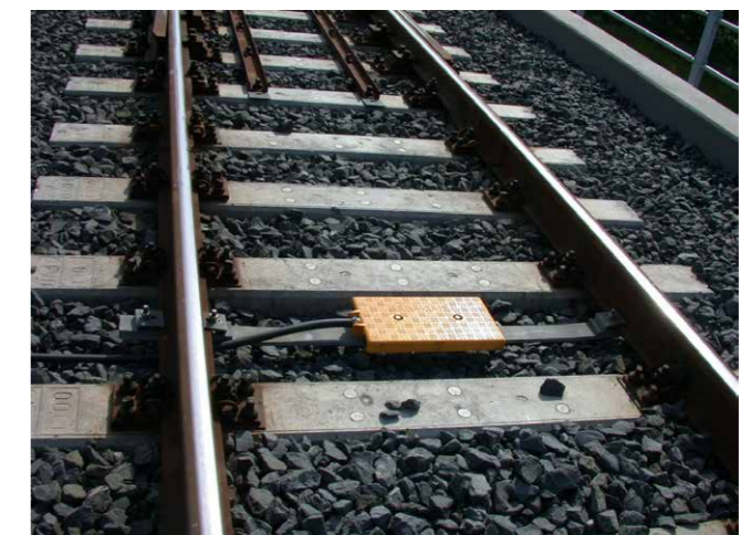
Het ontbrekende veiligheids- en waarschuwingssysteem ETCS FOTO: HALÁSZ ISTVÁN
