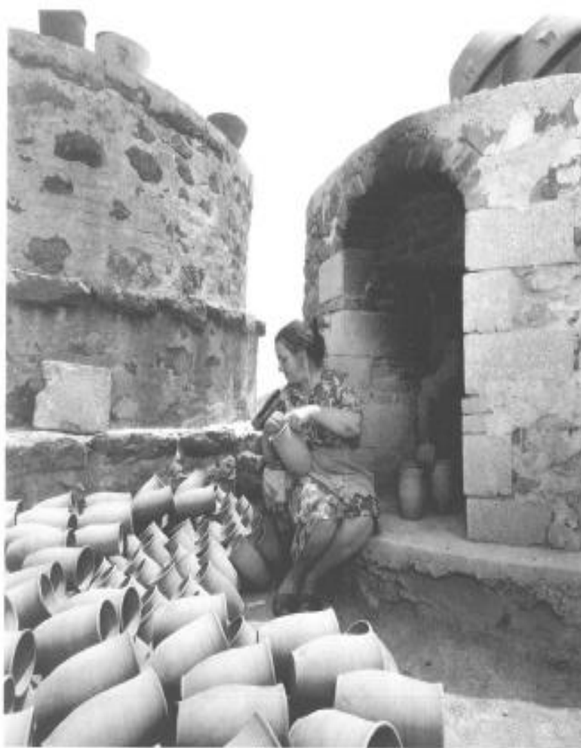
Τοποθέτηση από πάνω των τελευταίων στρώσεων στον κεραμικό κλίβανο. Εργαστήριο στον Άγιο Στέφανο, 1978.
