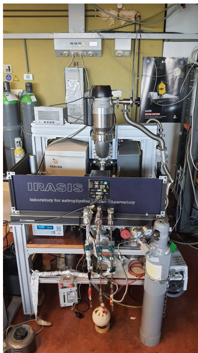
Figure 2: Een foto van IRASIS, de experimentele opstelling gewijd aan het bestuderen van de IR-spectra van interstellaire ijsanalogen
