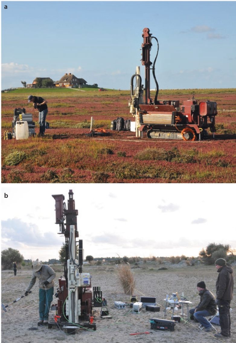
■ Abb. 14.1 a Direct-Push-Sondierung mittels HPT-Sonde bei Hallig Südfall (Nordfriesland). Über die elektrische Leitfähigkeit sowie die hydraulischen Eigenschaften der oberflächennahen Sedimente können z. B. die mittelalterliche Marschoberfläche sowie markante Sturmflutlagen identifiziert werden. b Seismische Drucksondierung (SCPT) an der Kaiafa-Lagune in Griechenland (siehe ■ Abb. 14.2), für die das Bohrgerät im Untergrund verankert ist. In relevanten Tiefen wird mittels Hammerschlag ein seismischer Impuls ausgelöst. Über das an der Sonde montierte Geophon wird die tiefenspezifische Ausbreitungsgeschwindigkeit der seismischen Wellen (in diesem Fall: P- und S-Wellen) aufgezeichnet. Im untersuchten Geoarchiv konnten Sedimente zweier historischer Tsunami-Ereignisse eindeutig erfasst und charakterisiert werden (vgl. ■ Abb. 14.2; Fotos: A. Vött 2017, 2018)
