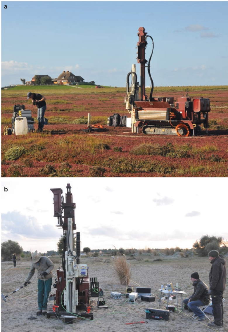
Abb. 14.1 a Direct-Push-Sondierung mittels HPT-Sonde bei Hallig Südfall (Nordfriesland). Über die elektrische Leitfähigkeit sowie die hydraulischen Eigenschaften der oberflächennahen Sedimente können z. B. die mittelalterliche Marschoberfläche sowie markante Sturmflutlagen identifiziert werden. b Seismische Drucksondierung (SCPT) an der Kaiafa-Lagune in Griechenland (siehe Abb. 14.2 ), für die das Bohrgerät im Untergrund verankert ist. In relevanten Tiefen wird mittels Hammerschlag ein seismischer Impuls ausgelöst. Über das an der Sonde montierte Geophon wird die tiefenspezifische Ausbreitungsgeschwindigkeit der seismischen Wellen (in diesem Fall: P- und S-Wellen) aufgezeichnet. Im untersuchten Geoarchiv konnten Sedimente zweier historischer Tsunami-Ereignisse eindeutig erfasst und charakterisiert werden (vgl. Abb. 14.2 ; Fotos: A. Vött 2017, 2018)
