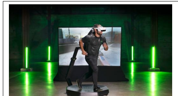
Figuur 7 Een door Virtuix ontwikkeld prototype-omnidirectionele loopband Bron: Virtuix
