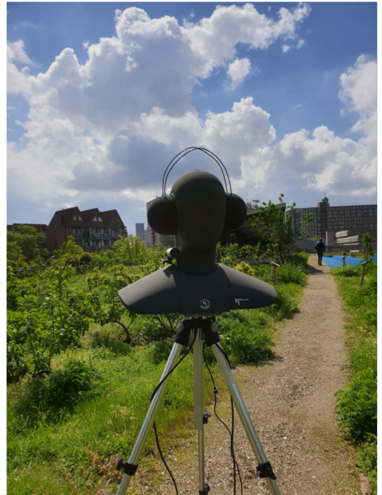
Head-Acoustics hoofd-schouder simulator opgesteld tussen de fruitbomen op het Luchtpark
