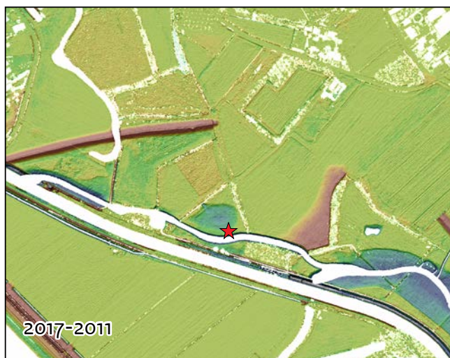
Afb. 2.2 Het Actueel Hoogtebestand Nederland (AHN) versie 2011 (AHN 2 ) en 2017 (AHN 3 ) en een vergelijking tussen de twee versies waarop duidelijk wordt waar afgegraven en opgehoogd is.
