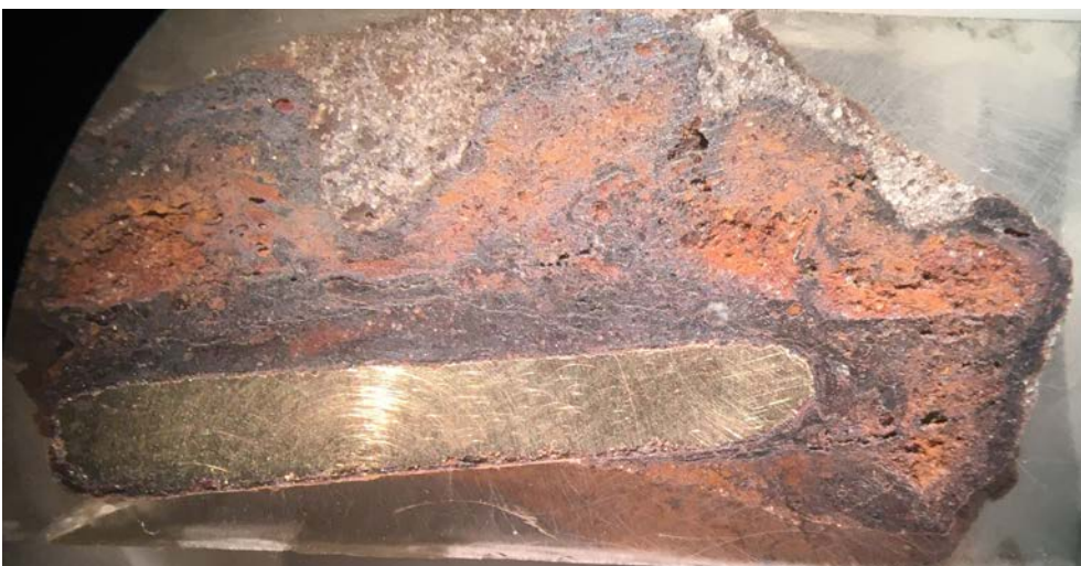
Afb 5.28 De doorgezaagde geïmpregneerde concretie. Het niet gecorrodeerde deel van de munt is goudkleurig, de corrosie en de ijzerconcretie hebben tinten die variëren van geeloranje tot zwart. Aan de rand komt enig zand voor dat niet is geïmpregneerd (beeld van lage-vergroting opvallend licht microscoop).
