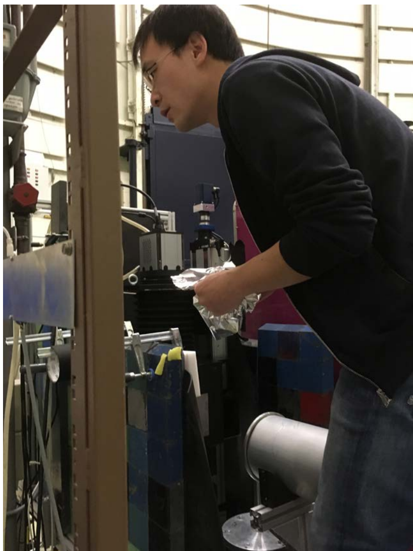
Afb. 5.26 Zhou Zhou plaatst de munt in de neutron tomografie opstelling FISH.
