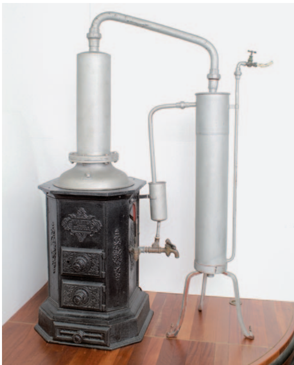
Destilleertoestel voor water uit het laboratorium van Van 't Hoff in Amsterdam.
