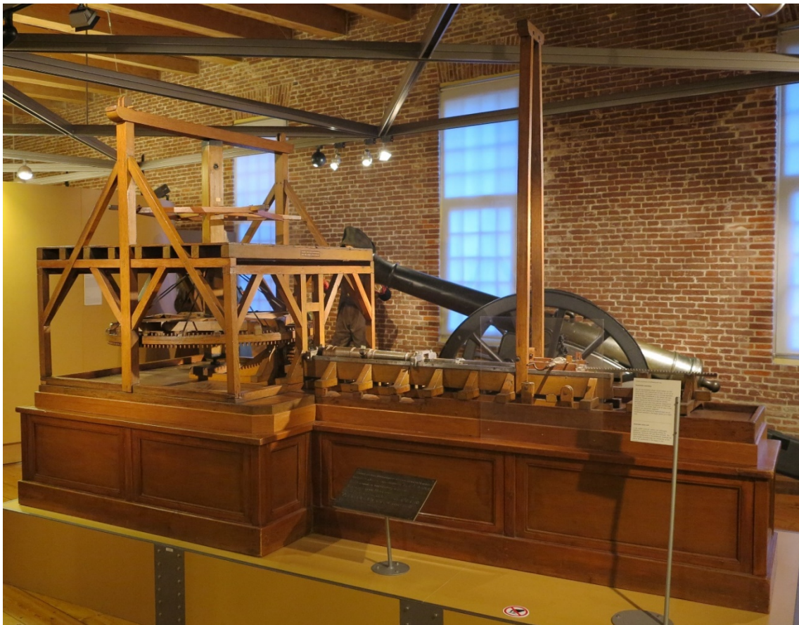
Model van de horizontale boorbank van de stadsgeschutgieterij te Amsterdam. In de 18 e eeuw stond dit model opgesteld in het stadhuis van Amsterdam. De foto toont de opstelling in het voormalige Koninklijk Nederlands Leger- en Wapenmuseum Generaal Hofer (Armamentarium) in Delft. Collectie Amsterdam Museum, inventarisnummer KA 14932. Foto: J.R. Verbeek, 1994.
