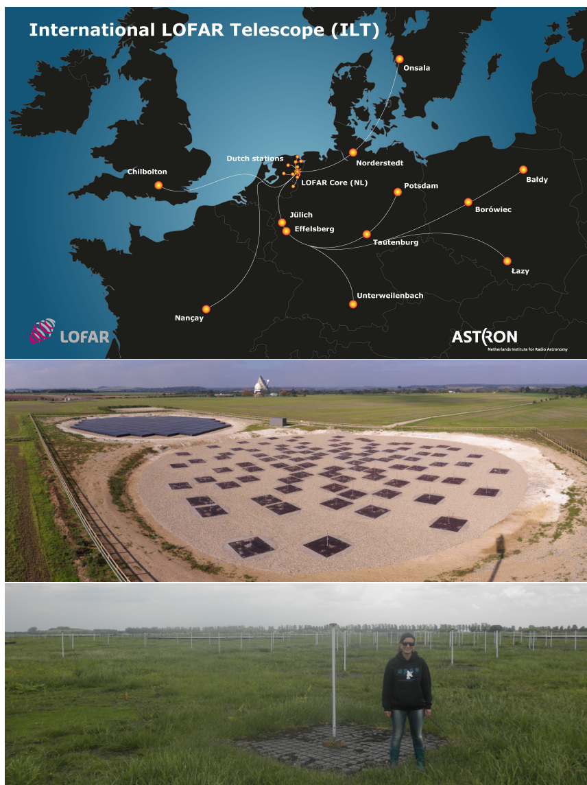
Figuur 4: Boven : De locaties van LOFAR-stations. De data in dit proefschrift werd genomen voor de bouw van de stations in Polen, toen de langste basislijn lag tussen Onsala en Nançay (1292 km). Midden : Het LOFAR-UK-station in Chilbolton. De LBA-antennes liggen op de voorgrond met daarachter de HBA-antennes bij elkaar onder een weerbestendige bedekking. Onder : Dipolen van een LBA-station in de centrale kern van LOFAR, met de auteur voor schaal.
