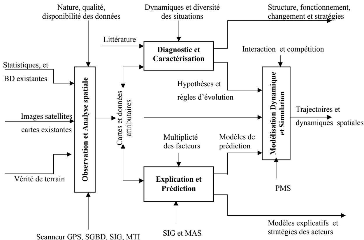
**Figure 6.4 : Diagramme fonctionnel de niveau 2 mettant en exergue les quatre principaux modules du SIE SMALL Savannah.**
