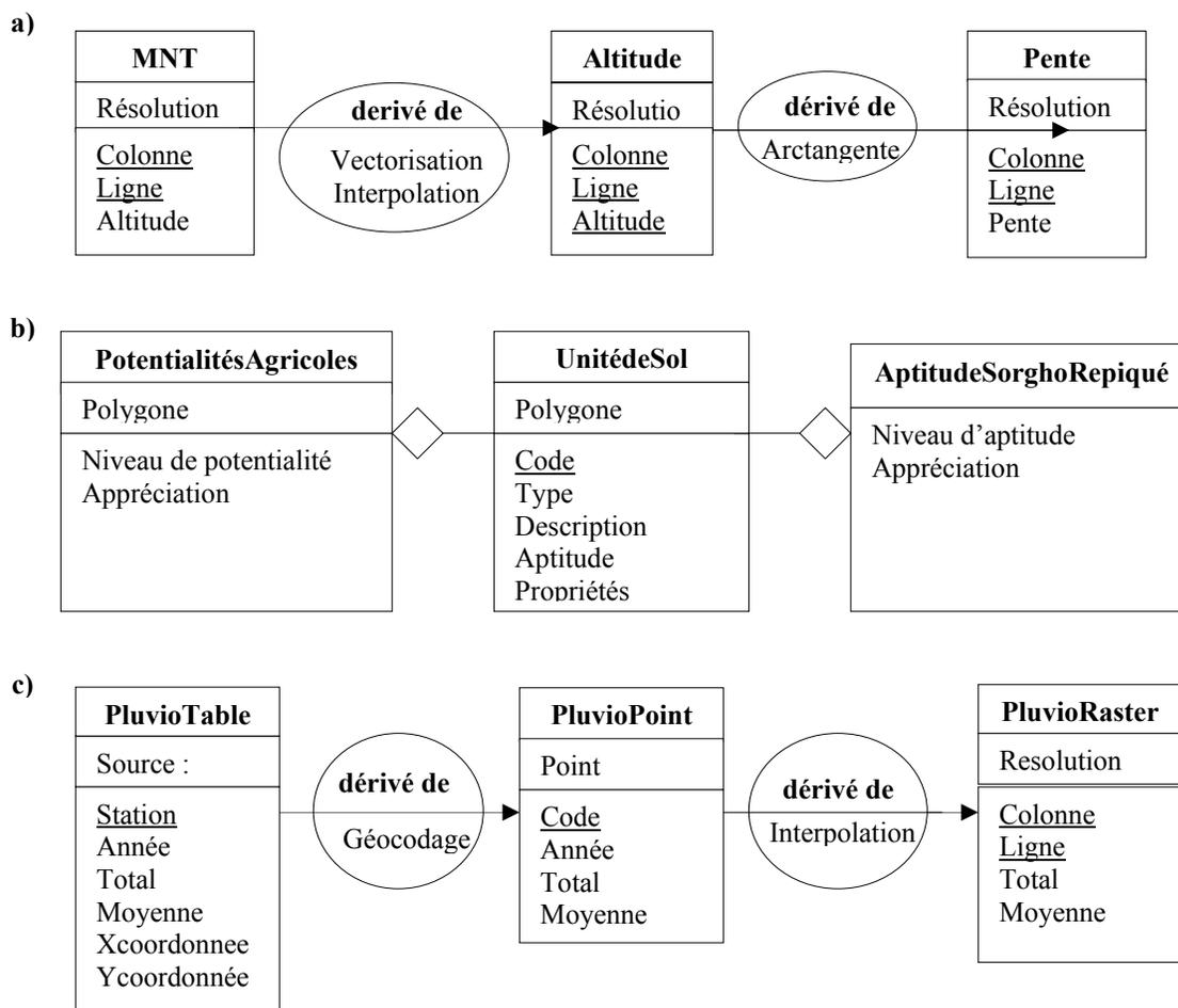
**Figure 6.10 : Exemples de structure de données sur les facteurs biophysiques. Les détails sur les fonctions d'interpolation et de calcul de pente sont décrits au chapitre 9. Les unités d'aptitude et de potentialité des sols sont composées d'unité de type de sol (voir chapitres 5 et 7).**
