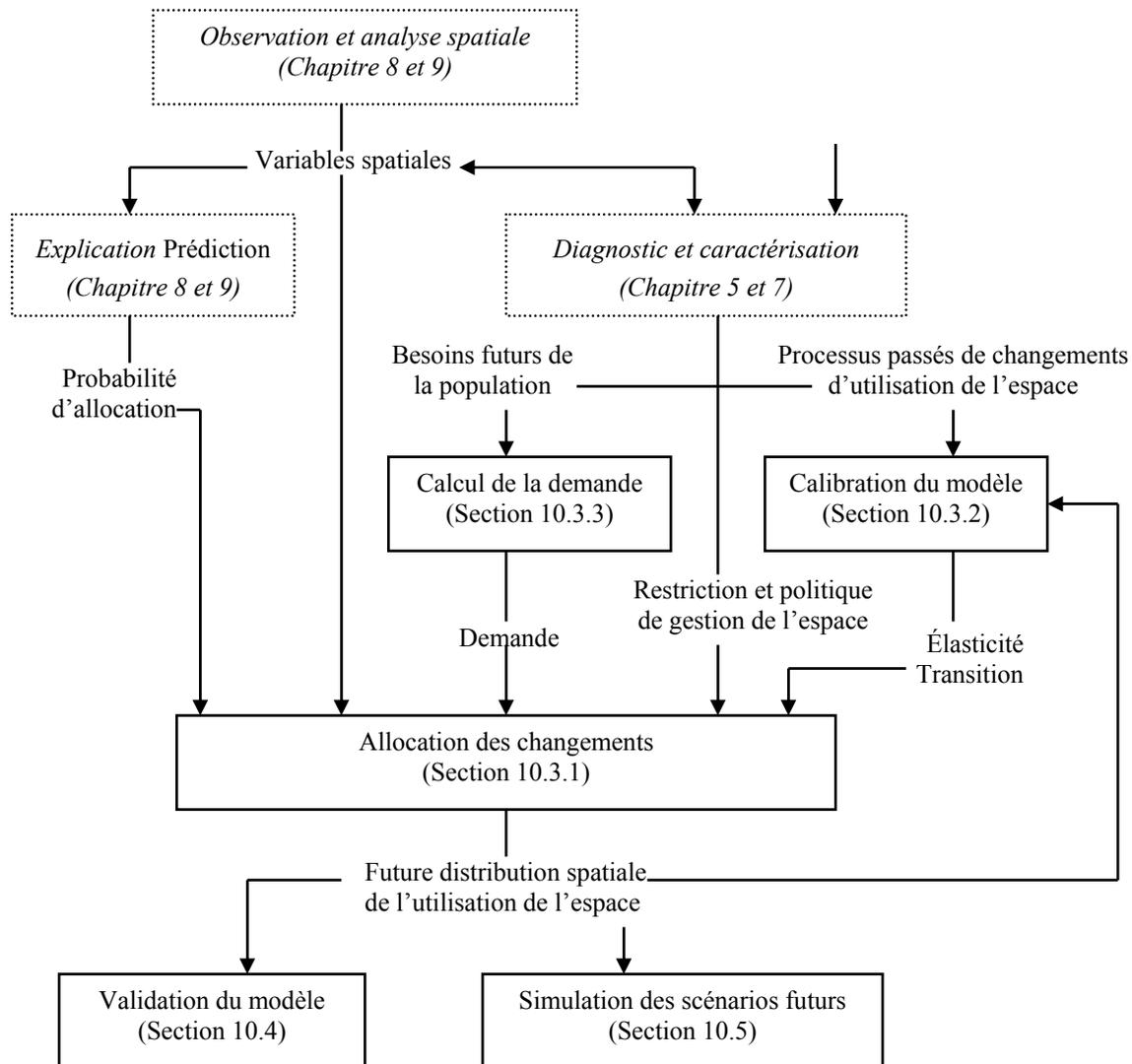
**Figure 10.1 : Flux d'informations entre les modules de SMALL Savannah et de la plate-forme CLUE-S. Le rectangle en pointillé et le texte en italique représentent les modules non utilisés dans cette application.**
