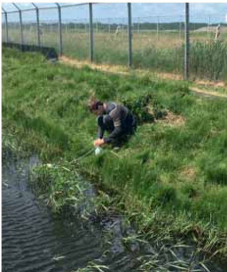
Mark die Passive Samplers uithangt in het oppervlaktewater om de verspreiding van een ZZS in beeld te brengen.
