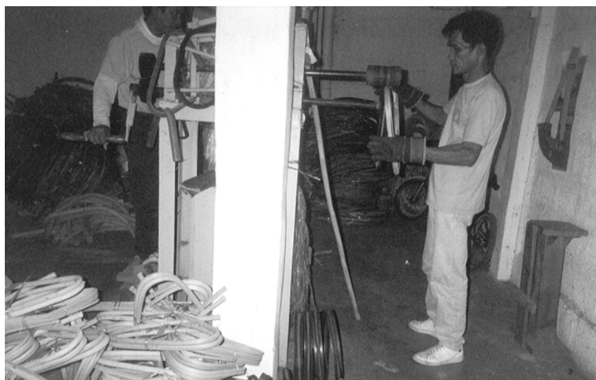
PHOTO 6.6 – Opération de cintrage de rotin en série dans une manufacture de Angeles
