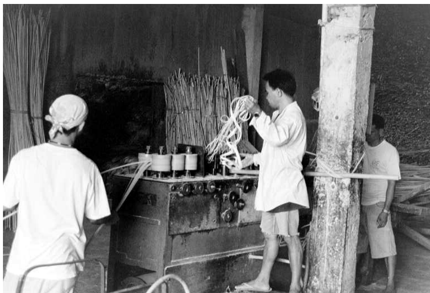
PHOTO 6.4 – Débitage du rotin par une 'wicker machine' dans une UPT de Angeles
