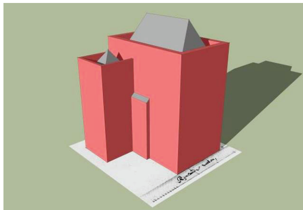
Figuur 385 Mogelijke vorm (schematisch) van 't Zant op basis van de opmeting van Post en de tekeningen van Roghman, Spilman en Van Solingen. Tek. auteur 2010.
