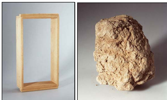
Een mal voor rechthoekige tichelstenen (RMV 5591-48) en een handgemaakte cilindrische tichel (RMV 5591-37).
