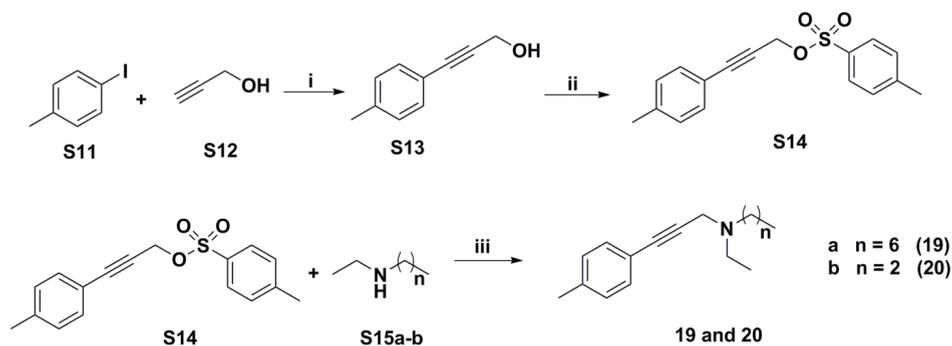
i)  $\text{PdCl}_2(\text{PPh}_3)_2$ ,  $\text{CuI}$ ,  $\text{Et}_3\text{N}$ ,  $\text{THF}$ , r.t.; ii) tosyl chloride,  $\text{KOH}$ ,  $\text{Et}_2\text{O}$ ,  $0^\circ\text{C}$  to r.t.; iii)  $\text{K}_2\text{CO}_3$ ,  $\text{DMF}$ , r.t.
