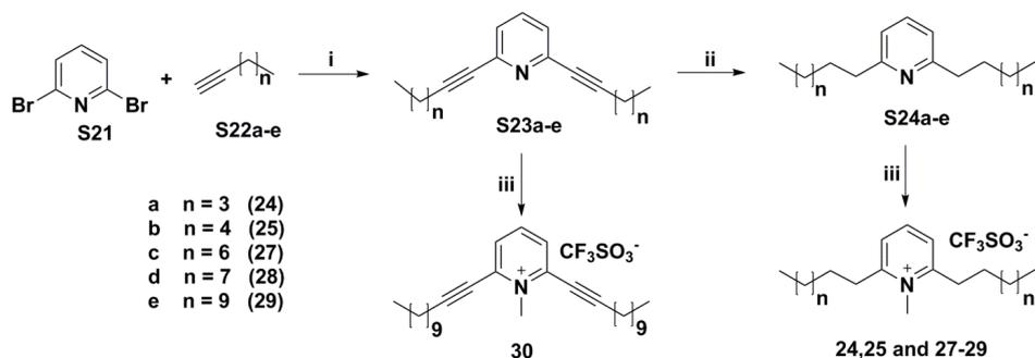
i)  $\text{PdCl}_2(\text{PPh}_3)_2$ , CuI,  $\text{Et}_3\text{N}$ , r.t.; ii) 10% Pd/C,  $\text{H}_2$ , THF, MeOH, r.t.; iii)  $\text{CF}_3\text{SO}_2\text{OCH}_3$ ,  $\text{CH}_2\text{Cl}_2$ ,  $0^\circ\text{C}$  to r.t.
