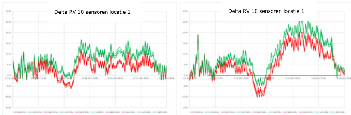
Figuur 6 Delta RV in procentpunten in het 1 e en 2 e weekend van november. De RV is in elke kantoortuin op 5 verschillende posities gemeten. Groene lijnen: beplante kantoor, rode lijnen: onbeplante kantoor.
