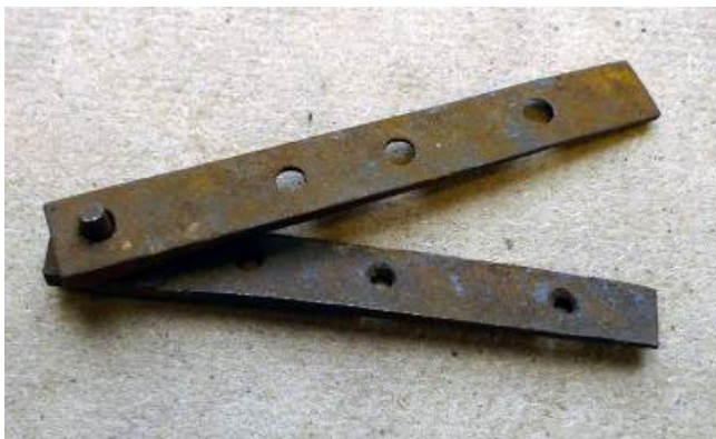
Hand gesmede speun met taps toelopende uiteinden, toegepast op witwerkers-meubels tussen circa 1650-1870. Maten: L.8 cm. Collectie Michiel van den Ent.
