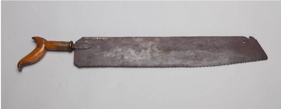
Handzaag met een buxushouten pistoolgreep. Datering: 1650-1800. Maten: L.84 x B.11 x D.3 cm. Collectie Nederlands Openluchtmuseum, Inv.nr.: NOM.33784-62.
