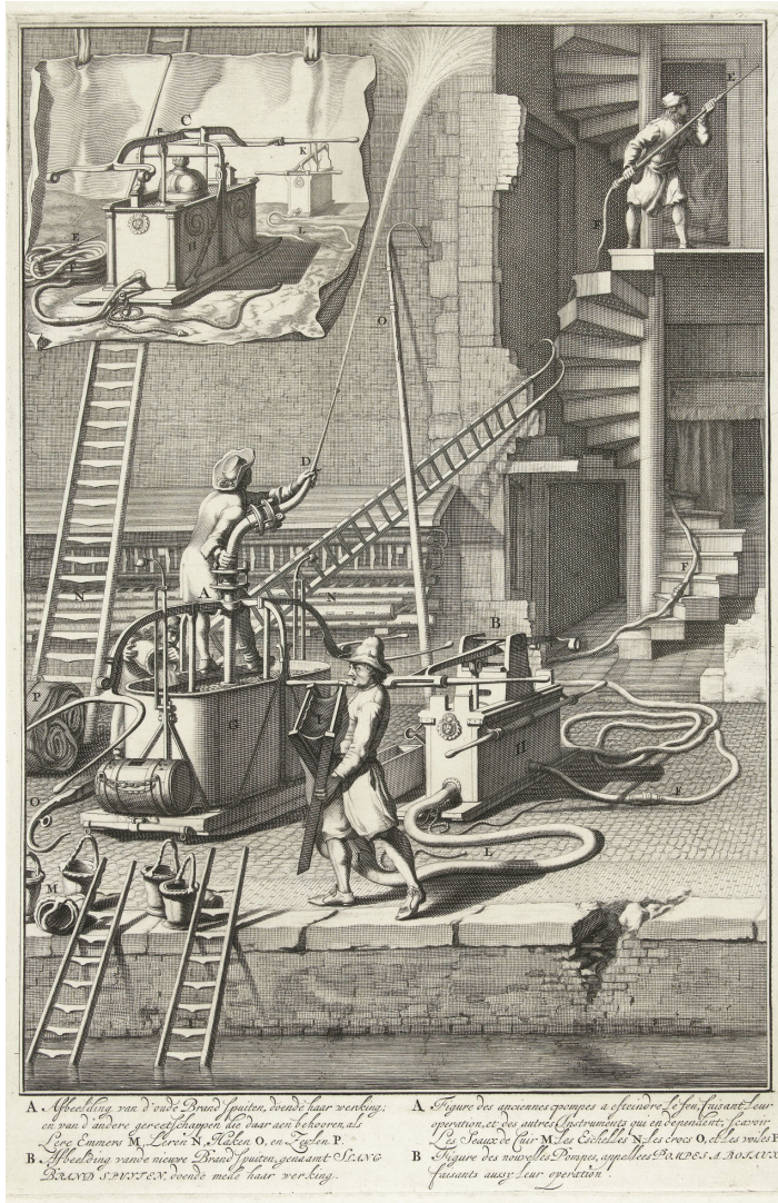
Fig. 3: Vergelijking tussen de werking en toepassing van oude brandspuiten en de nieuwe slangbrandspuiten. Links staat het oude model weergegeven en rechts het nieuwe systeem, waarbij waterslangen de verschillende elementen met elkaar verbinden. Door deze slangen, die een bereik van 300 meter hadden, was het voor het eerst mogelijk om tot de kern van de brandhaard te komen, zelfs al moest je door smalle stegen. Uit: Jan van der Heyden, Beschryving der nieuwlyks uitgevonden en geotrojerde slangbrandspuiten, en haare wyze van brand-blussen (Amsterdam 1690).
