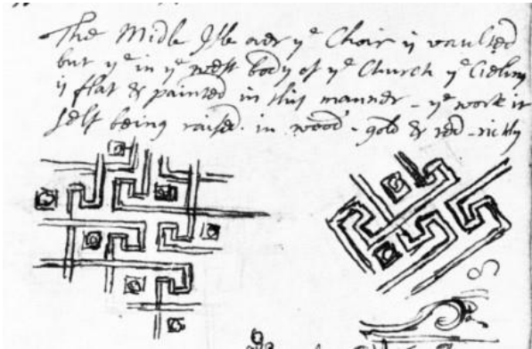
I.3.29A links: fragment uit het reisverslag van James Thornhill met twee tekeningentjes van het plafond van het schip van de kathedraal van Doornik (uit: Fremantle 1977a, II: p.57).
