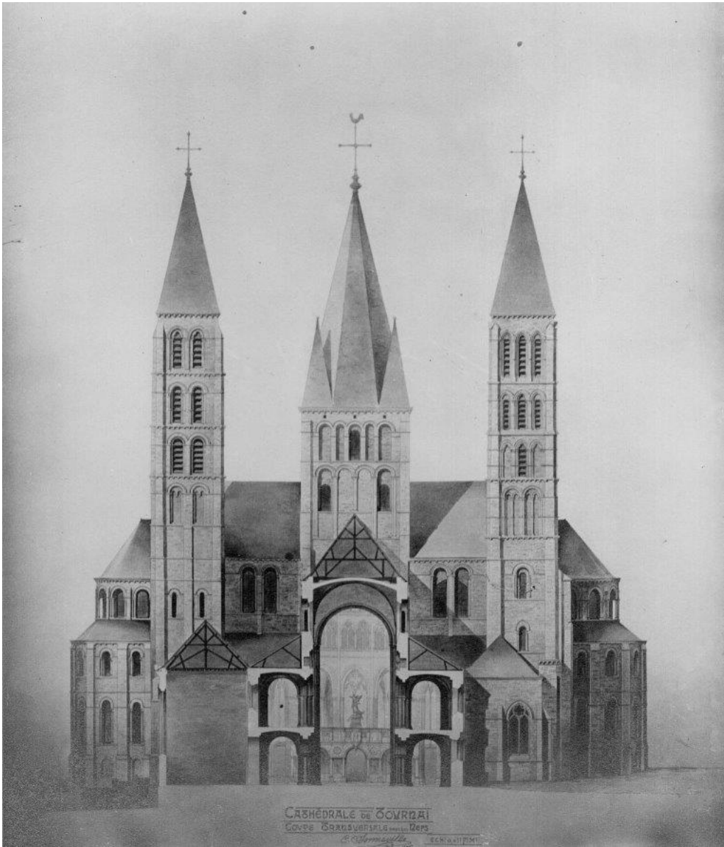
0.3A Tournai, cathédrale Notre-Dame 140 , doorsnede over het schip transept richting het oosten en aanzicht van het transept vanuit het westen, Constant Sonnevillle, 1905.
