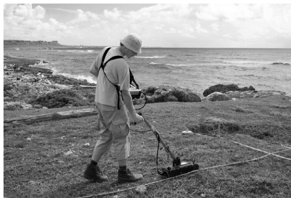
Slika 7. Georadarske meritve z visoko ločljivostno 900 MHz anteno (foto: Uroš Kirn).
