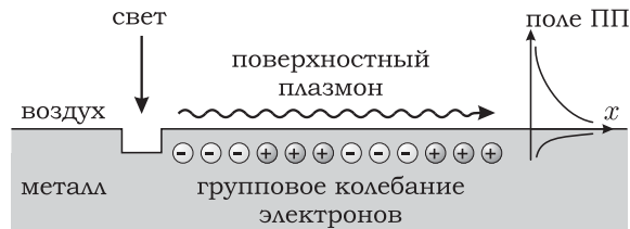
Рис. 2. Возбуждение поверхностного плазмона на поверхности металла.
