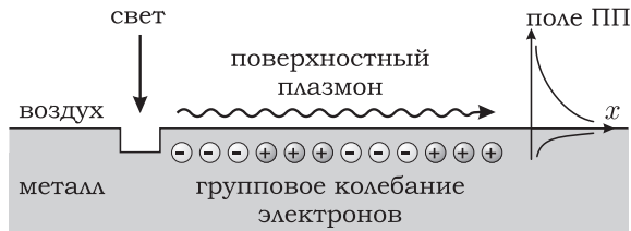
Рис. 2. Возбуждение поверхностного плазмона на поверхности металла.
