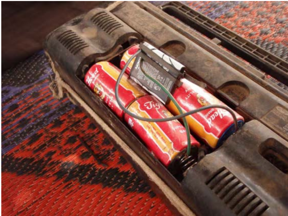
Photo 8.4 Recharge d'une batterie de téléphone mobile avec des piles électriques à partir des électrodes de la radio (2009)
