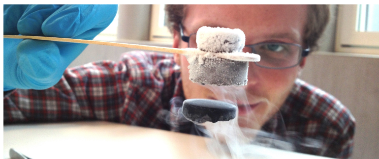
Figuur 3: Cupraten zijn bekend geworden door hun supergeleidende eigenschappen. Hier is een stuk yttrium-barium-koperoxide (YBCO) te zien, dat door middel van een magneet zwevend gehouden kan worden.
