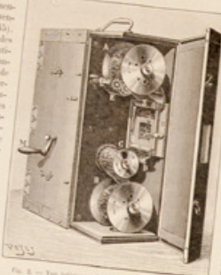
Fig. 2. — Vue intérieure du chronophotographe réversible de M. Denon.
