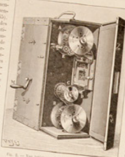
Fig. 2. — Vue intérieure du chronophotographe réversible de M. Denney.
