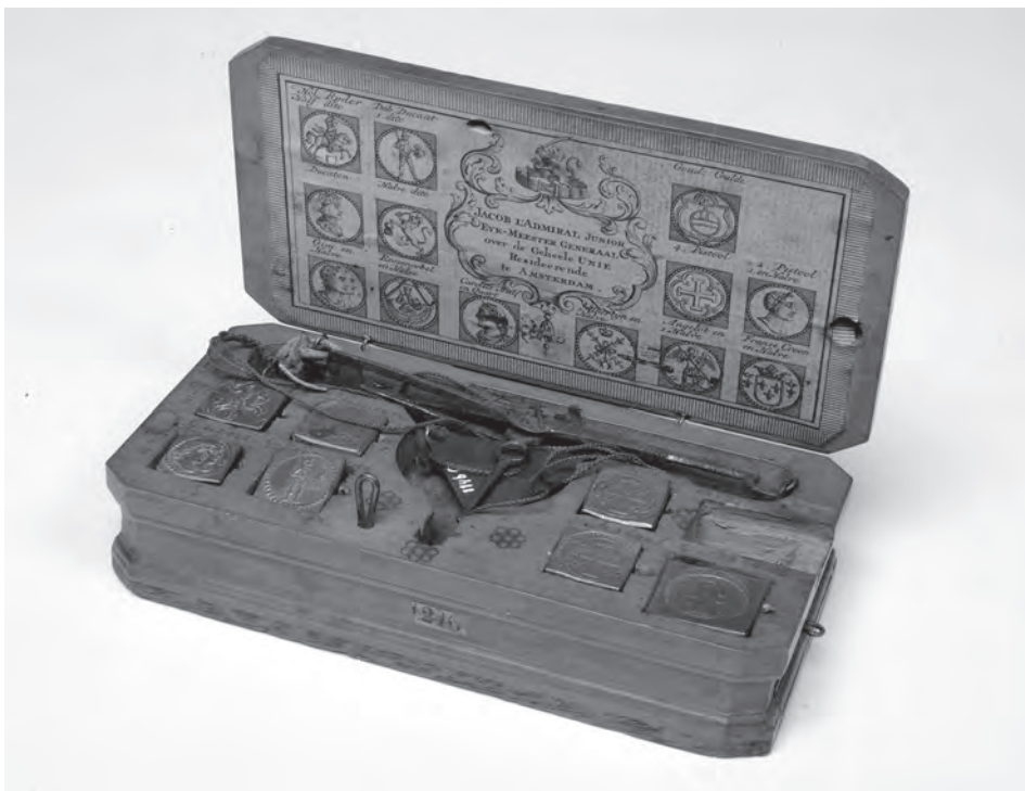
Afb. 19 Doosje met gewichten en balans om munten te wegen van Jacob Admiraal II jr.
