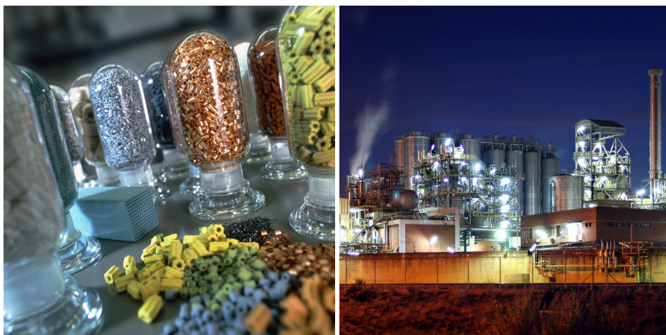
Figuur 2. Katalyse op industriële schaal. Links een aantal katalysatoren; te zien zijn de porieuze keramische korrels die geïmpregneerd zijn met heel kleine metaaldeeltjes[156]. Rechts de reactorvaten van een PVC kunststoffabriek, die zijn gevuld met dit soort korrels[157].
