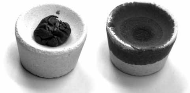
Afb. 18. Een cupel met metaalmonster, links vóór en rechts na bewerking. Particuliere collectie.
