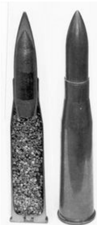
Afb. 4: Een doorsnede van een typisch eenheidspatroon waarbij de componenten duidelijk te zien zijn: onder in de hulsbodem zit het slaghoedje, daarboven de kruitlading en op het uiteinde de kogel.
