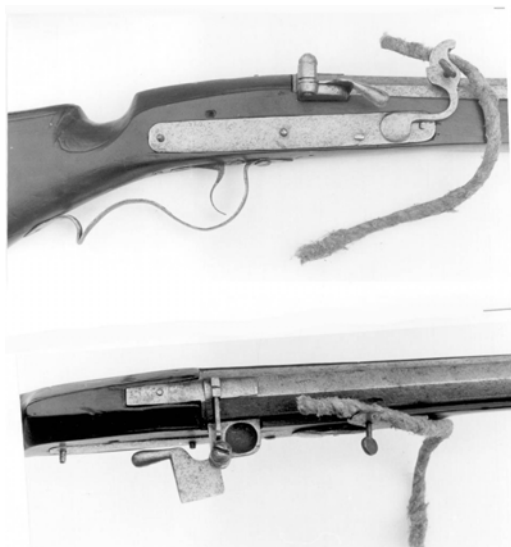
Afb. 1: Zij- en bovenaanzicht van een lontslotgeweer. Door de trekker over te halen beweegt het (hier niet) brandende bovenste deel van de lont in de pan, waarna het pankruit via een gaatje in de loop de hoofdloading ontsteekt. Collectie H. Visser.
