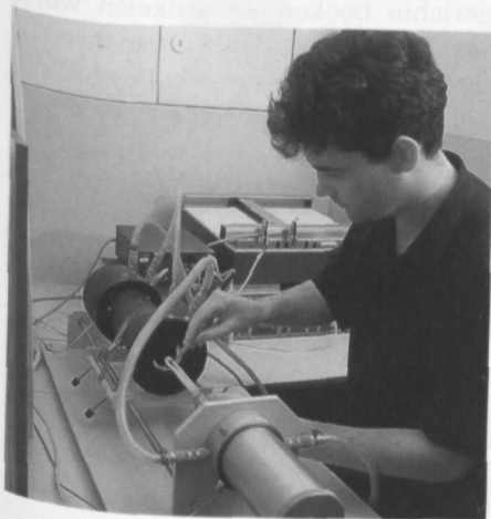
162 Bei der keramologischen Forschung wird ein Dilatometer verwendet. L'analyse céramologique est effectuée au moyen d'un dilatomètre. Ceramologisch onderzoek met behulp van een dilatometer.
