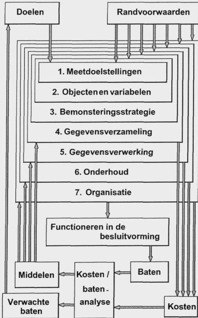
Figuur 2. Schematische weergave van het framework bij opzet (en gebruik van) een meetnet.
