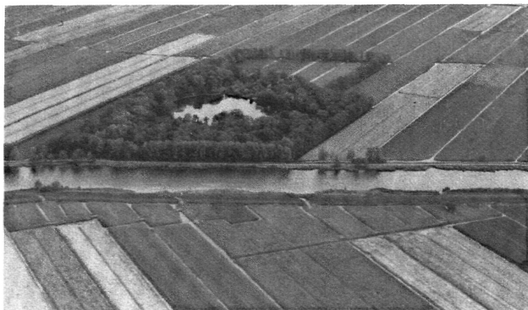
Afb. 17. Natuurbouw "avant la lettre", anno ± 1360. De dijk langs het boezemwater is opgeworpen met materiaal dat van de aanliggende percelen is afgegraven. Deze worden "uitstekken" of "aardhalingsstukjes" genoemd. Op de foto zijn ze duidelijk herkenbaar. Doordat de drassigheid slechts extensief gebruik mogelijk maakt, zijn het soms botanische juweeltjes met soorten als Spaanse ruiter, Moerasviooltje, Waterdriehblad, Blaaszegge en Stekelzegge. Helaas is een aantal uitstekken de laatste jaren opgehoogd, met name doordat ze sinds de ruilverkaveling veel beter bereikbaar zijn geworden; ze verdienen een beter lot.
