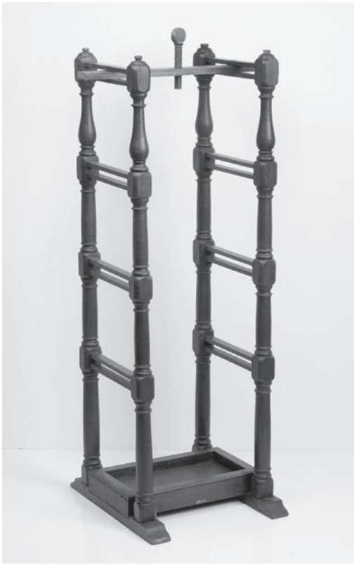
Fig. 2: 's Gravesande's fall apparatus. (Museum Boerhaave, V09630)
