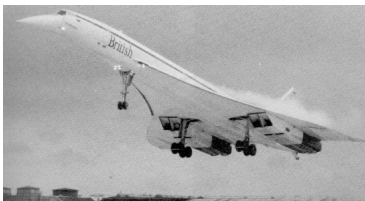
Figuur 8: De 'leading edge vortex' bij de Concorde (Barnard & Philpott, 1997)
